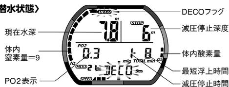
例えば (図16) は、無減圧潜水時間を超えたために減圧表示に代わり、6mの減圧停止深度に浮上するよう指示が出ています (減圧停止深度に向かって浮上中の状態)。ダイバーは直ちに、浮上速度に注意しながら水深約6.5m付近まで浮上して減圧を始めなければなりません。(他の表示は、減圧停止時間は1分、現在水深が7.8m、最短浮上可能時間は8分であることを示しています。また減圧状態を示すDECOフラグが点灯しています。)
