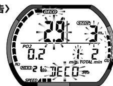
DECOフラグ及び現在水深、減圧停止深度、“DECO”文字表示、減圧停止時間が点滅、警告音3秒間×2回鳴鐘
