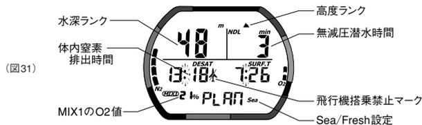
ダイビング終了後、体内窒素が残っている状態で、ダイブプランモードに入った場合は、その時点での体内窒素量がバググラフによって表示されています。
