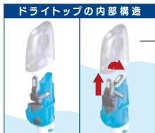
フロートの浮揚によってバルブがフタをして水の浸水を防止します。
