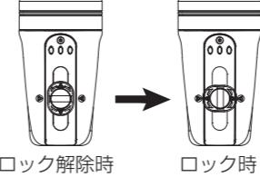
スイッチが縦方向になって△マークが合っている時はロック状態、横方向になっている時は解除状態です。
